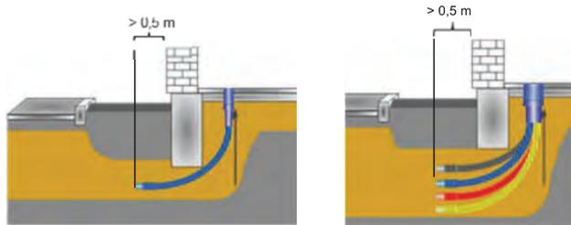
Gebäudeeinführungen sind nach den geltenden Vorschriften für Bauwerksdurchdringungen und deren Abdichtung für erdverlegte Leitungen auszuführen. Die Gebäudeeinführung ist Bestandteil des Gebäudes. Für den Einbau und die Abdichtung ist der Anschlussnehmer verantwortlich. Die Erstellung der Gebäudeeinführung durch den Netzbetreiber ist gesondert zu vereinbaren.
