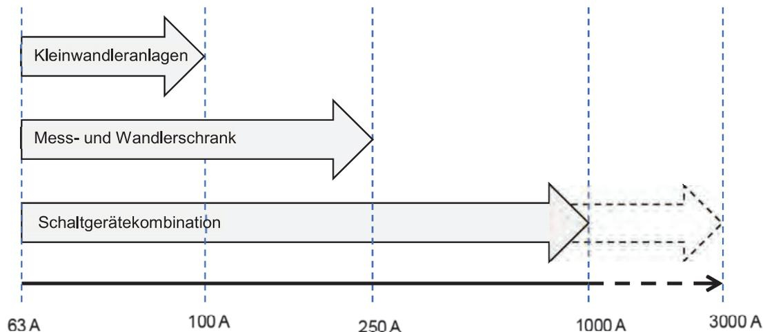
Zählerschrankkombinationen mit Zählerplätzen nach DIN VDE 0603-2-1 sind für Direktmessung bis max. 63A geeignet, darüber hinaus sind halbindirekte Messungen einzusetzen. Sofern eine Herstellererklärung für eine Niederspannungs-Schaltgerätekombinationen nach DIN EN 61439 (VDE 0660-600) vorliegt, sind auch Direktmessungen bis 100A möglich.
