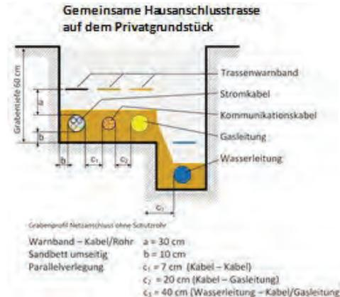
Die Kabel im Kabelgraben sind steinfrei einzusanden. Im Allgemeinen dürfen Kabeltrassen nicht überbaut werden (außer bei Kabelverlegung im Schutzrohr) und es dürfen keine tief wurzelnden Pflanzen vorhanden sein.
