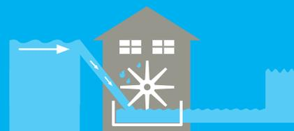
Fließendes Wasser wird gestaut. Große Durchflussmengen erbringen hohe Leistung. Diese Kraftwerke liefern zuverlässig und werden zur Grundlaststromversorgung eingesetzt.
